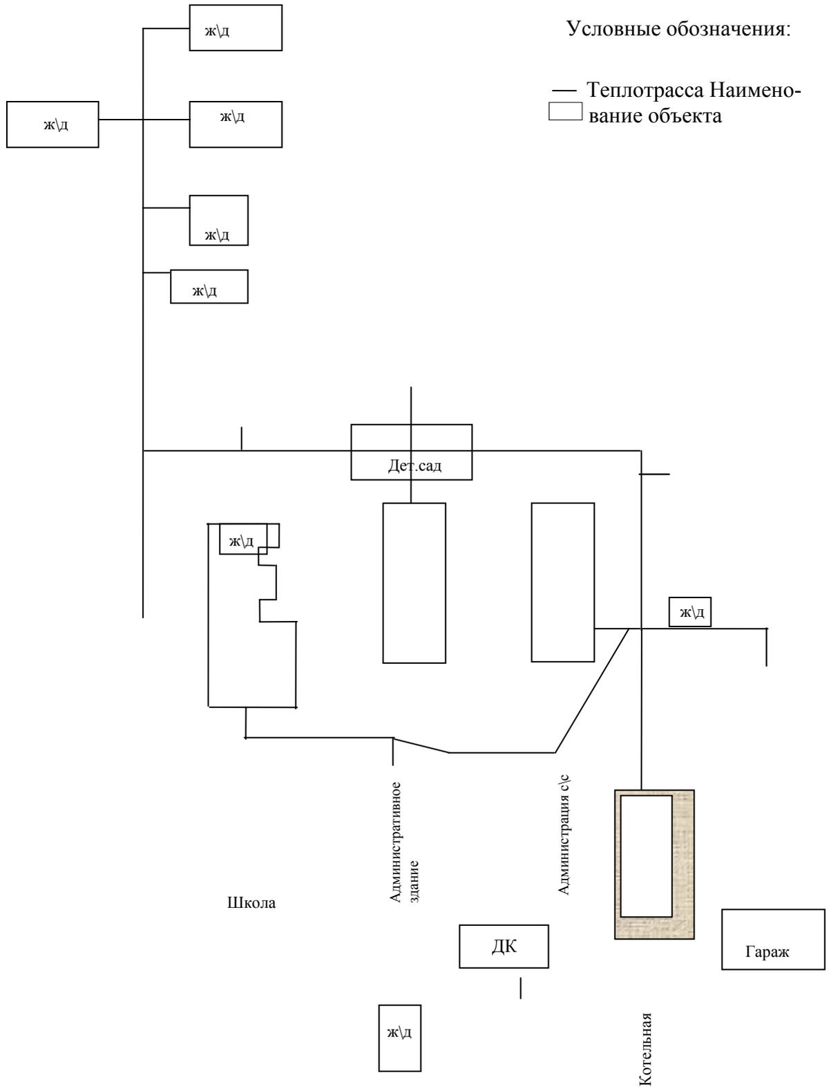
Рис. 2.3.1. Схема тепловой сети котельной МУП «ТЕПЛОЦЕНТРАЛЬ» с. Стуково
